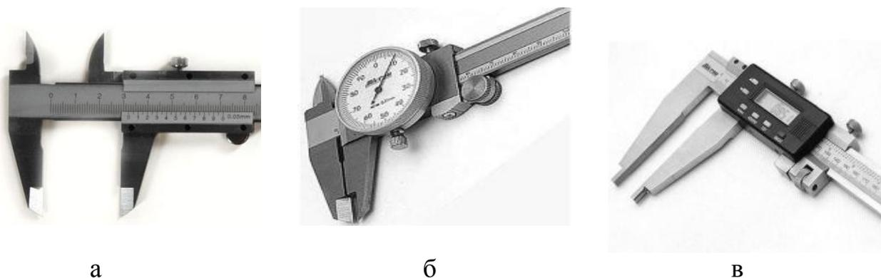
Рис.12. Виды отсчётных устройств штангенциркулей
