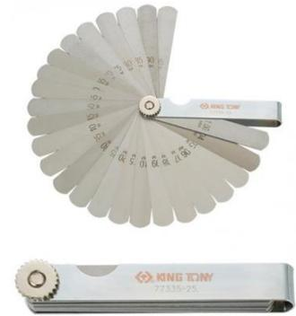
Рис.3. Щуп измерительный
